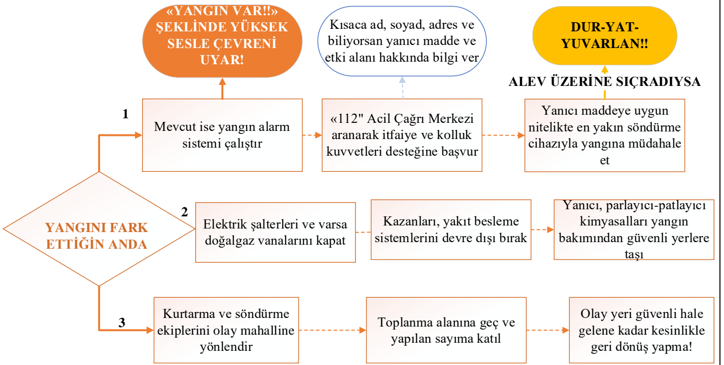
Şekil 4: Olası yangın durumunda müdahale planı.
